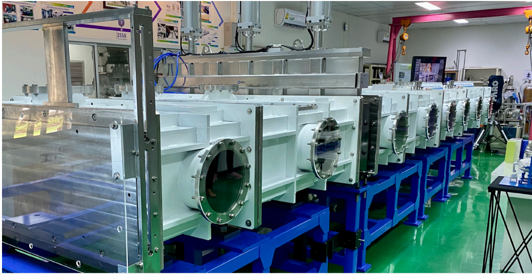
เครื่องเคลือบกระจกระดับอุตสาหกรรมสำหรับโครงการ CTA ที่พัฒนาขึ้นโดย สช. และ สดร.
