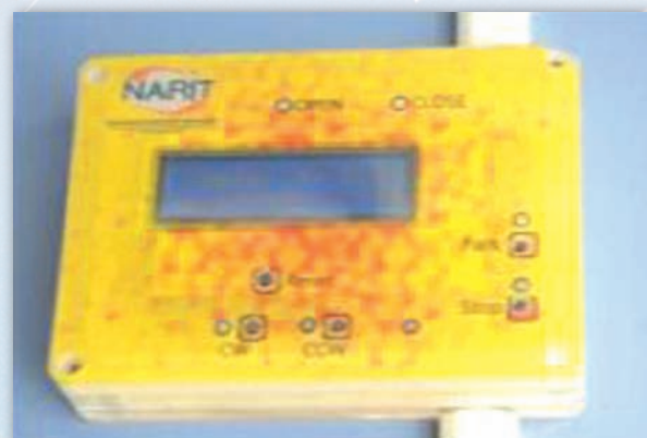
กล่องอิเล็กทรอนิกส์ควบคุมหอดูดาว An electronic box controlling the movement of the dome
