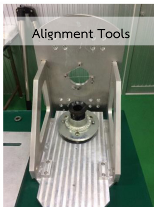
เป็นชุดสำหรับทำ Alignment สำหรับกระจก 2.4 ม.
