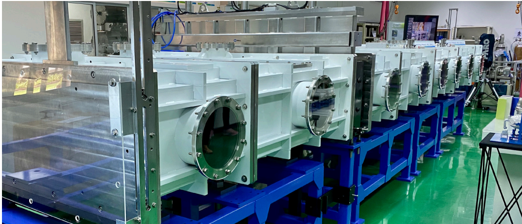
เครื่องเคลือบกระจกระดับอุตสาหกรรมสำหรับโครงการ CTA ที่พัฒนาขึ้นโดย สช. มสท. และ สดร.
