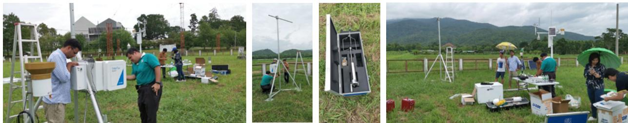
ติดตั้งเครื่องวัดกําชาร์บอนไดออกไซด์และไอน้ำแบบช่องเปิด (Open Path CO<sub>2</sub>/H<sub>2</sub>O/CH<sub>4</sub> Flux Analyzer)
