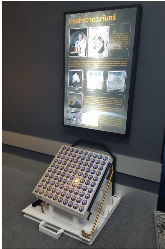
แผนภาพที่ 5.5 อุปกรณ์แสดงการวัดระยะทางระหว่างโลกและดวงจันทร์โดยใช้เลเซอร์และแผ่นสะท้อน
