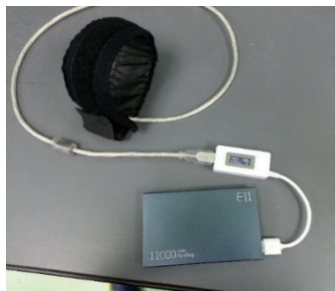
ฮีตเตอร์สำหรับกล้อง DSLR เพื่อใช้เวลารายภาพกลางคืน
