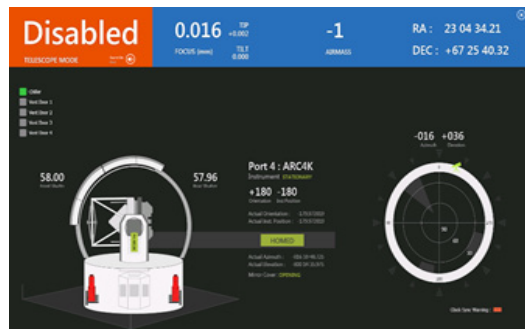
ระบบควบคุมกล้องโทรทรรศน์ 2.4 เมตร ที่ออกแบบใหม่
