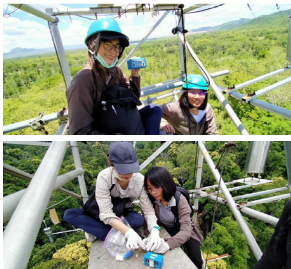
ลงพื้นที่เพื่อเก็บตัวอย่างอากาศเพื่อศึกษาความผันแปรตามฤดูกาลของการปลดปล่อยไอโซพรีนจากป่าในภาคเหนือของประเทศไทย โดยทำการวัดค่าอากาศด้วยเครื่องวัดขนาดอนุภาคระดับนาโนเชิงแสง
