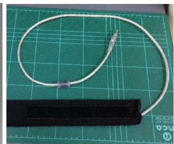
ฮีตเตอร์สำหรับกล้อง DSLR เพื่อใช้เวลารายภาพกลางคืน
