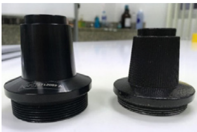
ออกแบบ Adaptor ต่อแกน Counter-weight ของกล้องโทรทรรศน์
