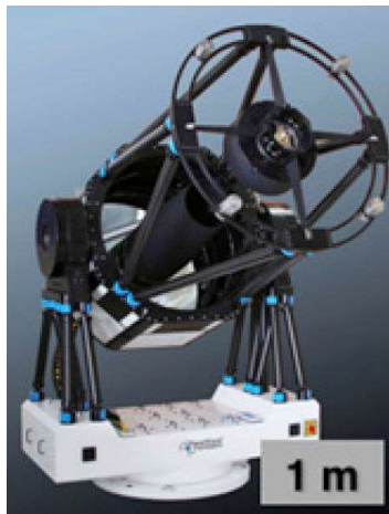
ภาพประกอบที่ 2.9 กล้องโทรทรรศน์ขนาดเส้นผ่านศูนย์กลาง 1 เมตร ที่นำมาติดตั้ง ณ ดาดฟ้าของอาคารควบคุม ที่มา: http://www.narit.or.th/index.php/telescope/tno . สืบค้นเมื่อ 6 ธันวาคม 2563
