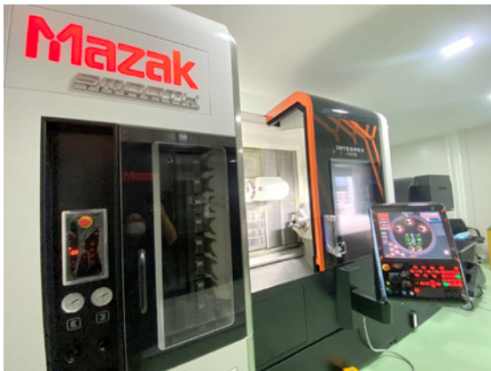
CNC Turn Mill - เครื่อง CNC ที่กัดและกลึงโลหะได้ในเครื่องเดียว / 5-Axis CNC - เครื่อง CNC 5 แกน
