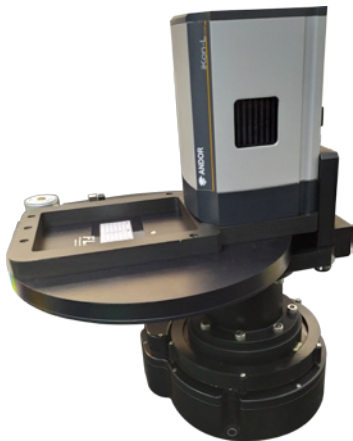
ตัวต่อสำหรับเชื่อมกล้องโทรทรรศน์กับซีซีดี (CCD Adaptor for telescope)
