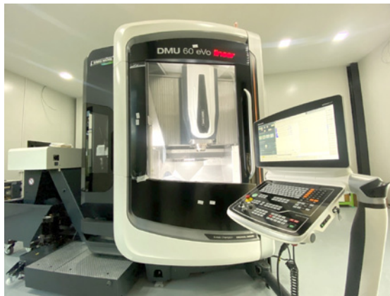
CNC Turn Mill - เครื่อง CNC ที่กัดและกลึงโลหะได้ในเครื่องเดียว / 5-Axis CNC - เครื่อง CNC 5 แกน
