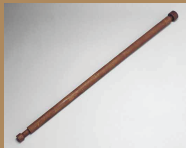
รูปที่ 6 กล้องโทรทรรศน์แบบหักเหแสง ตัวแรกที่กาลิเลโอสร้าง
