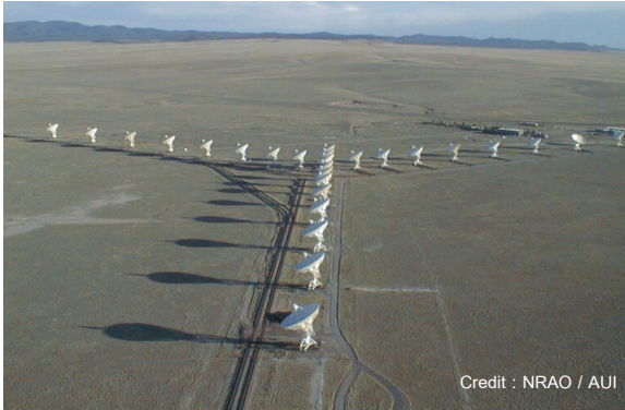
ภาพที่ 28 อาเรย์ของกล้องวิทยุวีแอลเอ (VLA : Very Large Array) ประกอบไปด้วยกล้องโทรทรรศน์วิทยุขนาด 25 เมตร จำนวน 27 ตัว วางจัดเรียงอย่างเป็นระบบ ที่รัฐนิวเม็กซิโก ประเทศสหรัฐอเมริกา
