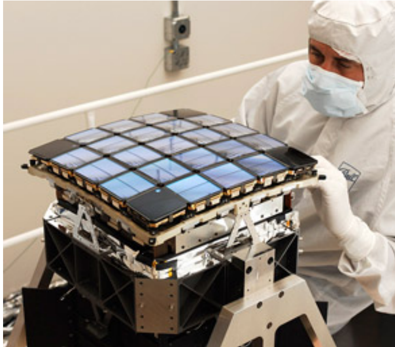
รูปที่ 8.3: อุปกรณ์ตรวจวัดของดาวเทียม Kepler ประกอบด้วย CCD จำนวน 42 ชิ้น CCD แต่ละชิ้นมีขนาด 50 \times 25 mm และมีความละเอียด 2200 \times 1024 pixels (ภาพโดย โครงการกล้องโทรทรรศน์อวกาศ Kepler)
