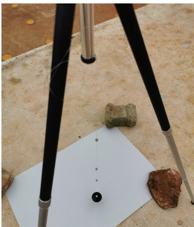
รูปที่ 1 แสดงการจัดอุปกรณ์ เพื่อวัดความยาวเงาสั้นสุด
