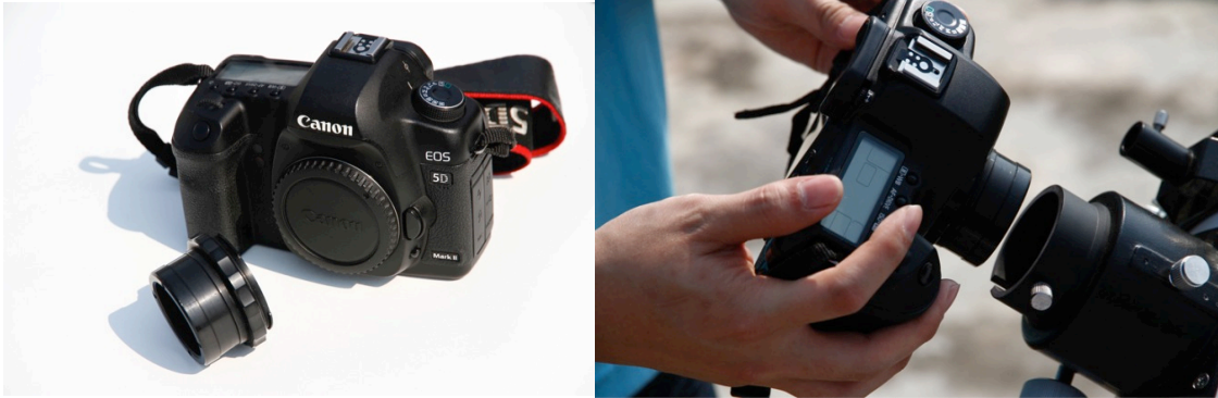
รูปที่ 23 : การต่อกล้องถ่ายภาพ DSLR ผ่าน Adaptor เข้ากับกล้องโทรทรรศน์
