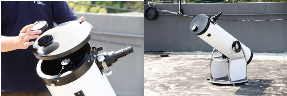
รูปที่ 21 : การติดตั้งแผ่นกรองแสงสำหรับดวงอาทิตย์ (Solar Filter) บนกล้องโทรทรรศน์ ชนิดสะท้อนแสงแบบดอปโซเนียน (สำหรับโรงเรียนในเครือข่ายโครงการกระจายโอกาสการเรียนรู้ดาราศาสตร์)
