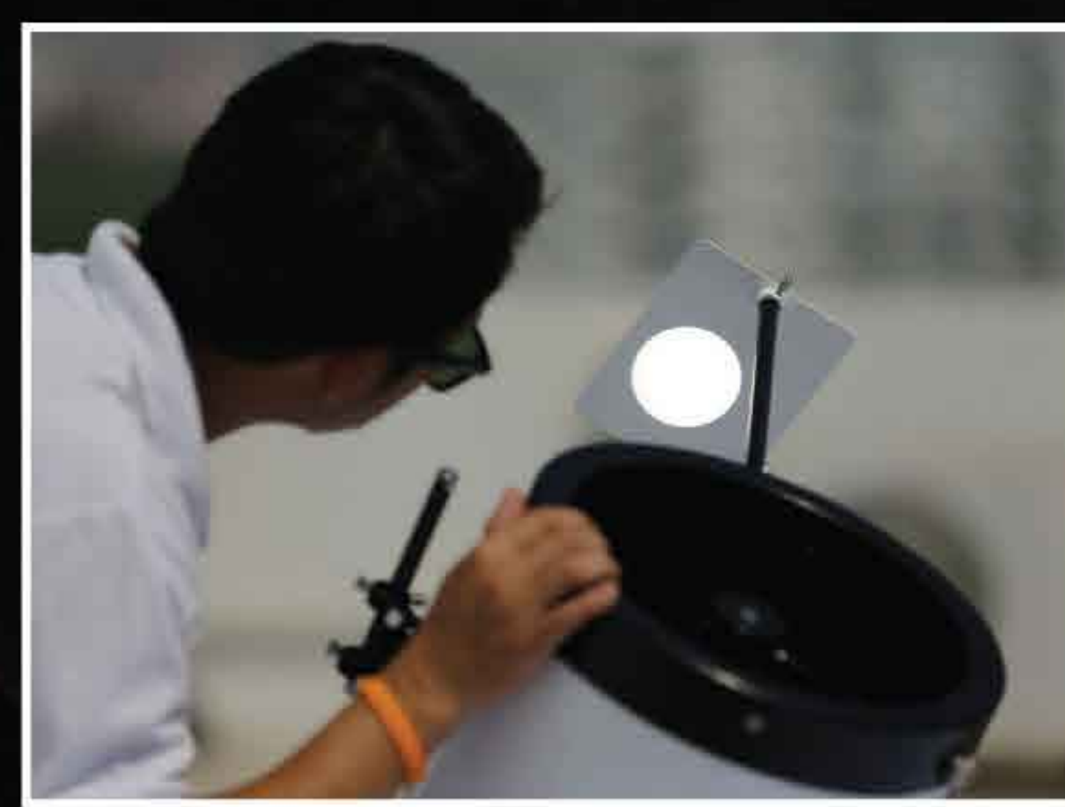
ใช้กล้องโทรทรรศน์รับแสงจากดวงอาทิตย์ แล้วตั้งฉากรับภาพที่ออกมาจากเลนส์ใกล้ตา
