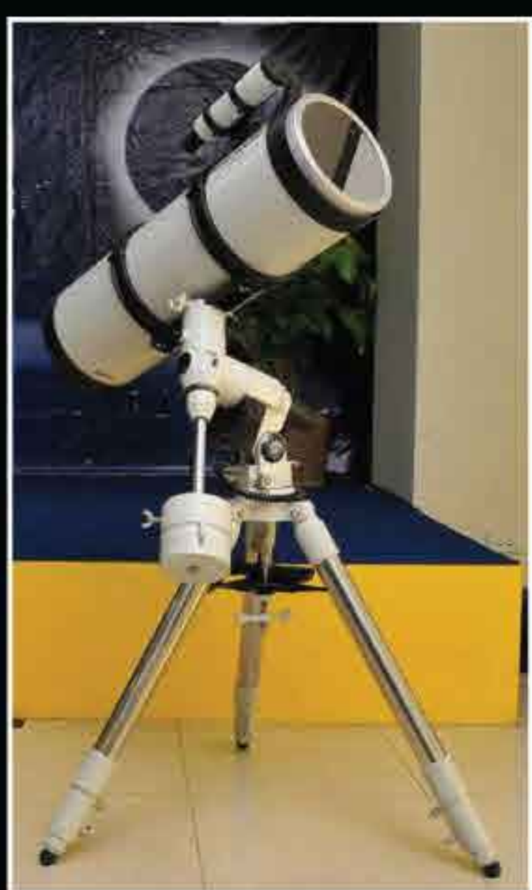
กล้องโทรทรรศน์ติดแผ่นกรองแสง แผ่นกรองแสงแบบกระจกเคลือบโลหะ
