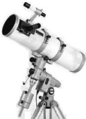
รูปที่ 11 กล้องโทรทรรศน์สะท้อนแสงติดตั้งบนฐานยึดพิกัด ศูนย์สูตร โดยการตั้งฐานกล้องให้แกนไรท์แอสเซนชันขนานกับแกนหมอบของโลก
